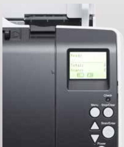
Встроенная подсветка повышает функциональность LCD-панели управления
